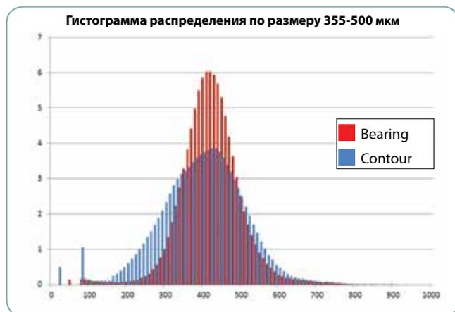
Во фракции 355-500 мкм в диапазон попали 71% частиц **Bearing nsPVA** и 51% частиц **Contour**.
